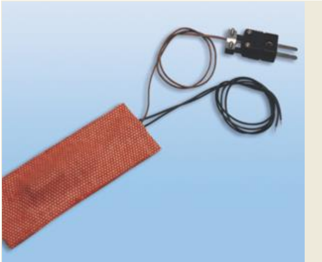
Fig:16 Riscaldatore flessibile isolato in silicone ed integrazione di termocoppia con connettore. Involucro protettivo addizionale in silicone e cavi di alimentazione isolati in teflon.
