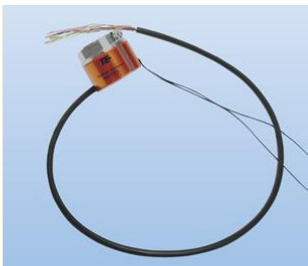
Riscaldatore flessibile isolato in kapton laminato montato su componente meccanico metallico cilindrico. Il riscaldatore consente l'operatività di un decoder ottico da -15^{\circ}\text{C} fino a -46^{\circ}\text{C} .
