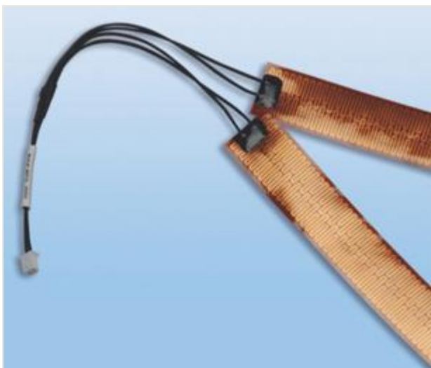
Riscaldatori flessibili isolati in kapton. Fili di alimentazione isolati in teflon con uscita protetta e rinforzata da resina Epoxy nera per alta temperatura e uniti da connettore Zif (Zero Insertion Force).
